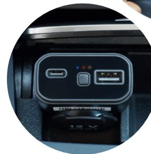
3. Wenn die LEDs aufleuchten, ist das Gerät richtig angeschlossen und kann verwendet werden
