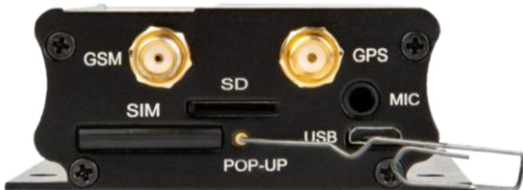
Die verwendete SIM-Karte muss im **Standart-Format** sein. Damit die SIM-Karte in den Tracker eingelegt werden kann, muss zuvor das SIM-Kartenfach geöffnet werden und der sogenannte **SIM-Kartenslot** herausgeholt werden. Dazu wird der gelbe kleine Knopf auf der Vorderseite des Gerätes mithilfe eines spitzen Gegenstandes betätigt. Das obere Bild zeigt die Öffnung mithilfe einer Büroklammer. *Diese ist nicht im Standardlieferungsumfang enthalten.*
