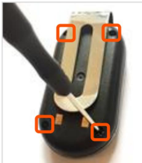
Zunächst muss das vordere Gehäuse des EASY Finders abgenommen werden. Lösen Sie hierzu bitte die vier kleinen **Schrauben** auf der Rückseite des Gerätes mit dem beigelegten
