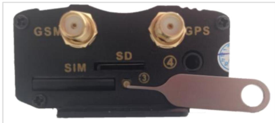
La tarjeta SIM utilizada tiene que estar en **formato estándar**. Para que la tarjeta pueda ser introducida en el rastreador tiene que abrir la apertura de la SIM y sacar el **soporte para la SIM**. Para eso, presione el botón ubicado en la parte frontal del dispositivo con la ayuda de un objeto puntiaqudo. La imagen de arriba muestra la apertura con la ayuda de una aquija para tarjetas SIM. *Esta no está incluida en el pedido.*
