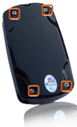
Tout d'abord, le boîtier avant de le boîtier du MINI Finder Finder doit être retiré. Dévissez pour cela les quatre petites **vis** à l'arrière de l'appareil avec les tournevis qui ont été mis en complément.
