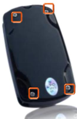
Tout d'abord, le boîtier avant de le boîtier du MINI Finder doit être retiré. Dévissez pour cela les quatre petites **vis** à l'arrière de l'appareil avec les tournevis qui ont été mis en complément.
