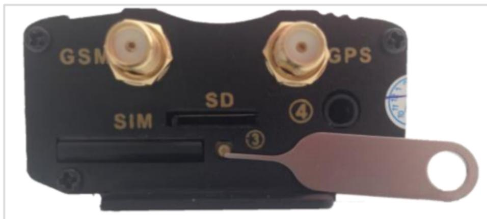
In modo che la SIM Card possa essere inserita nel Tracker, è necessario anzitutto aprire lo scomparto ed estrarre lo slot per la scheda. Per fare ciò, si deve premere il piccolo tasto giallo sulla parte anteriore del dispositivo con l'aiuto di un oggetto appuntito. I contatti magnetici devono essere rivolti verso l'alto. In seguito, lo slot con la SIM Card può essere reintrodotta nello scomparto.
