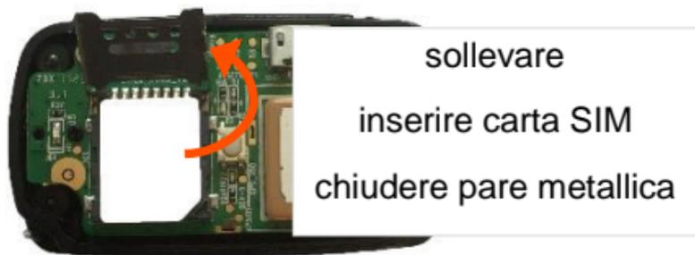
**Aprire** l'alloggiamento della carta SIM **spingendo** la parte metallica **verso l'alto**. Poi, potete **aprire** l'alloggiamento della carta SIM **sollevandola**.
